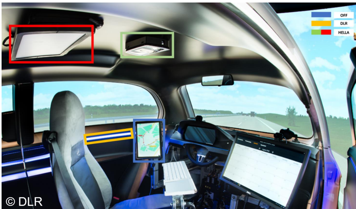
Abbildung 2: Aufbau des Demonstrators im Fahrsimulator. Die Elemente des Innenraums werden von farbigen Rechtecken eingerahmt (orange: HMI für Kommunikationsmodus Awareness, blau: Display HMI für Navigationssystem, rot: Umgebungslicht, grün: Matrix-LED-Leselicht).
